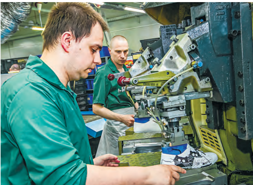
Для скрепления подошвы с верхом обуви используют в основном два метода. Один из них – литевой.
